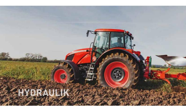
Beim FORTERRA CL beträgt diese 77 kN und beim FORTERRA HSX / HD 85 kN. Der FORTERRA HD bietet einen zusätzlichen 4-teiligen Hydraulikverteiler mit Elektrohydraulischer Bedienung. Dies Kombiniert mit Aufhängern der Kategorie III, erhalten Sie ein breites Spektrum an verwertbaren Geräte die angeschlossen werden können.
