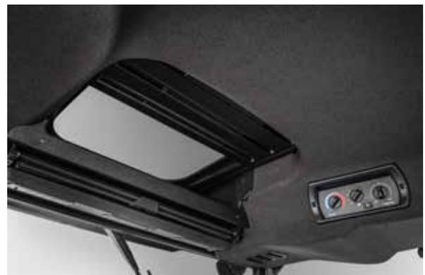
Das Dachfenster gewährleistet gute Überschaubarkeit bei der Arbeit mit dem Frontlader.
