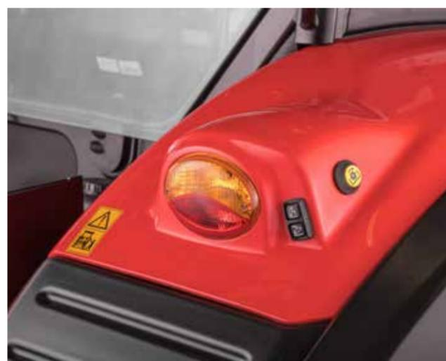
Die Zapfwelle kann genau wie die Arme der Dreipunktaufhängung direkt mit den Tasten am hinteren Kotflügel des Traktors gesteuert werden.
