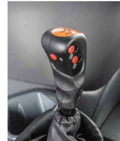
Anstatt aufs Kupplungspedal zu treten, kann zur Änderung der Geschwindigkeitsstufen auch die Kupplungstaste am Schalthebel genutzt werden. Dies eliminiert den Verschleiß der Fahrkupplung.
