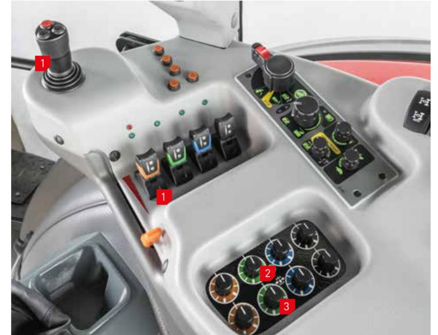
1. Umschalter steuern die hydraulischen Sektionen I-IV. Die Farben an den Umschaltern entsprechen den Farben der Schnellkupplungsdeckel. Die Steuerung der III. und IV. Sektion (ggf. die Steuerung der vorderen Hydraulikkreise, sofern eingebaut) kann auf Joystick-Steuermodus umgeschaltet werden.
