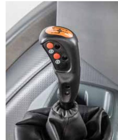
Der Wechsel der Schaltstufen des Wandlers erfolgt über Tasten am Schalthebel. Bei gewähltem Automatikmodus werden die Wandlerstufen ohne Fahrereingriff automatisch geschaltet.
